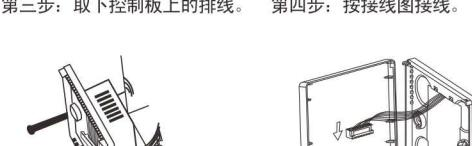
第三步：取下控制板上的排线。
