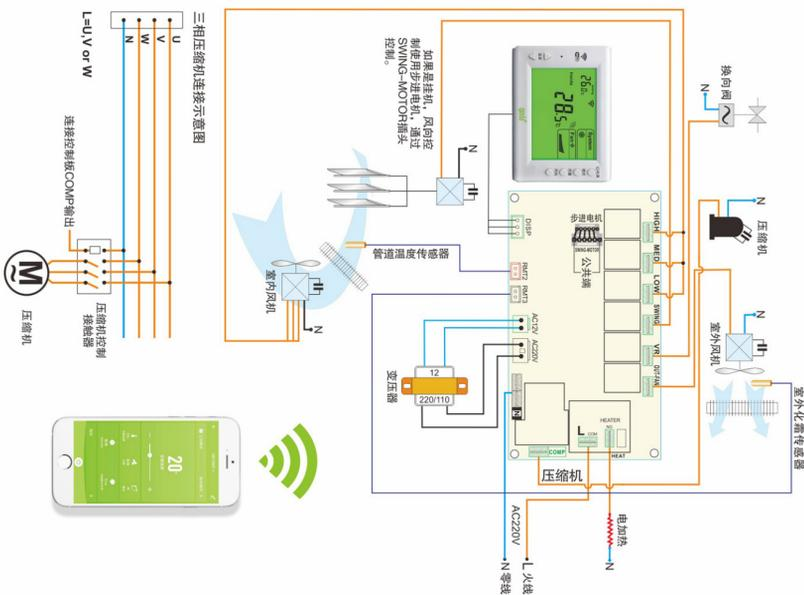
⚠ 若用户使用变频空调，本产品的压缩机电器输出端切勿直接用在变频压缩机上。
