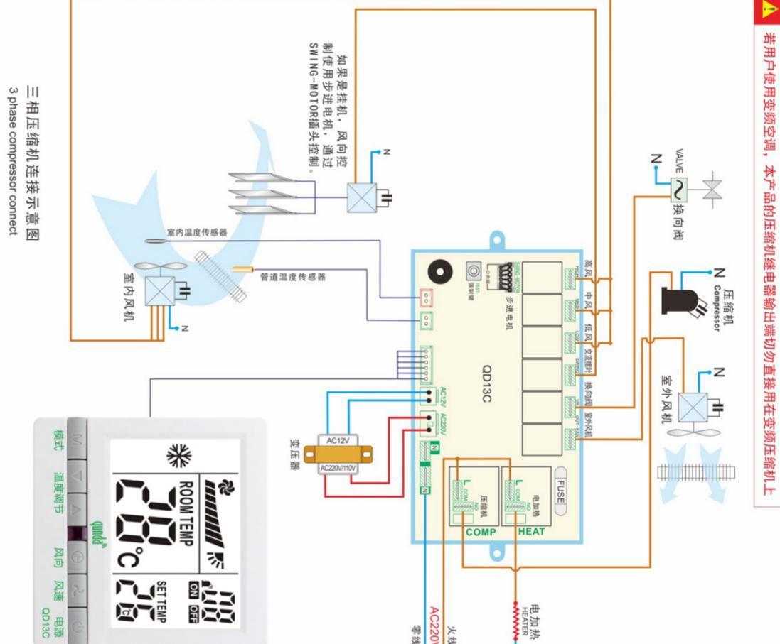
**A 若用户使用变频空调，本产品的压缩机继电器输出端勿直接用在变频压缩机上**
